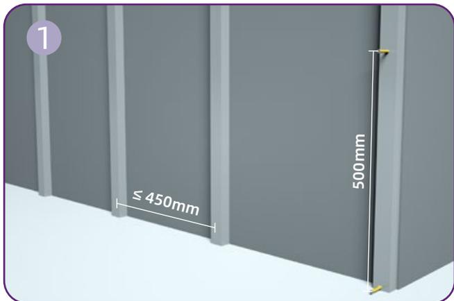
确保墙面平整且坚固。墙板必须安装在龙骨上，且与墙面的距离在200mm以上，以保证良好的通风和排水。每隔500mm使用膨胀螺丝将龙骨固定在墙面，两支龙骨的中心间距不超过450mm。
